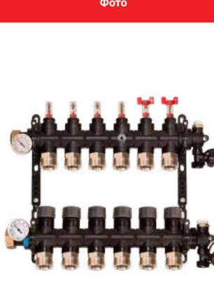
**Коллекторная группа (PAD/GF) 1"xPUSH-16 с расходомерами, воздухоотводчиками и дренажем с PUSH соединениями для трубы 16мм. Подключение магистрали 1" НГ**
