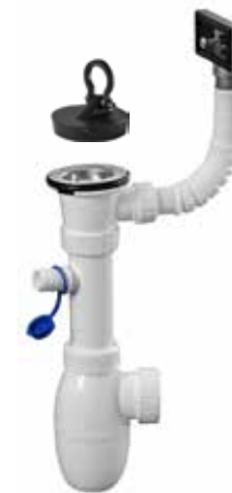
Сифон для мойки с подводкой для шланга, гофрпереливом и нержавеющей решеткой Ø70мм
