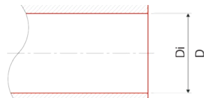
Размеры трубы FV PP-RCT HOT
