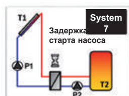
System 7 = Система 7 1 коллектор (T1) 2 насоса (P1/P2) 1 бак (T2) с задержкой работы насосов
